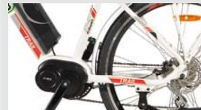
Motore centrale FIVE estremamente silenzioso, con coppia fino a 90Nm
