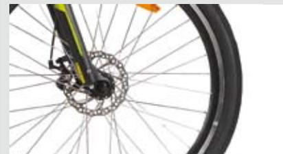
Freni a disco idraulici anteriore e posteriore
